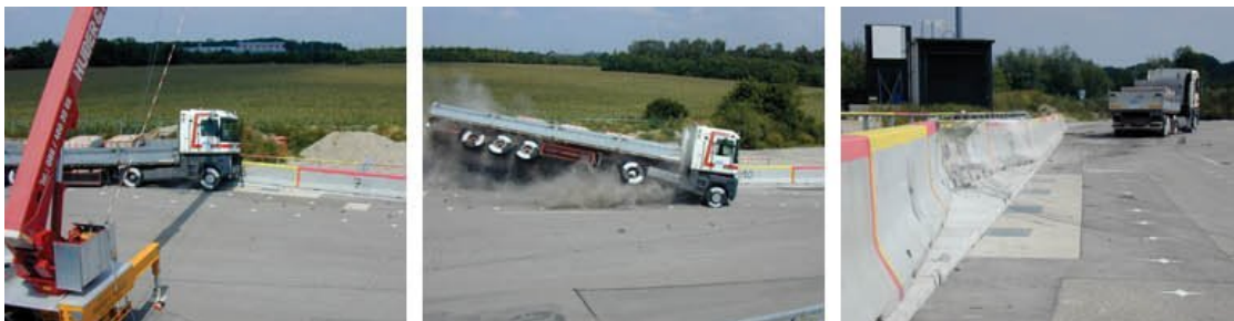
Abbildung 4: Crash-Test mit LKW (Quelle: MABA Fertigteilindustrie, Wiener Neustadt, Österreich).
