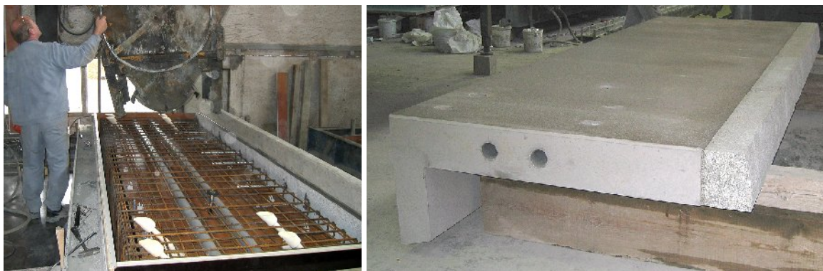
Abbildung 1: Planungsgerechte Werksfertigung der Fertigteile
